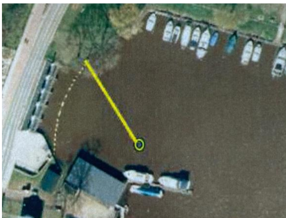
Ijzeren paal met schuine lijn om de waternavel 'in de hoek te drijven'.
