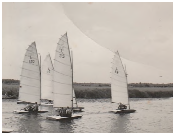
De Lark deed in het begin van de jaren 1930 zijn intrede in de watersport. In die jaren was een bootje zelf bouwen niet alleen traditie, het was vaak voorwaarde om te kunnen varen. Vooral in de crisisjaren, toen iedere bezuiniging meegenomen was. De Lark had een voor die tijd opvallend vlermuisttuig met doorlopende latten, een zeiloppervlak van 11 m2 en dat op een bootje van 4,00 x 1,40 meter.
