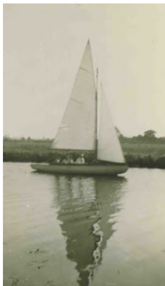
Een Sharpie is een houten zes meter lang en slechts 1.42 meter breed klassieke open zeilboot met gaffelzeil en genua. De Sharpie was uitverkoren tot Olympische boot bij de Olympische spelen van 1956 in Melbourne.
