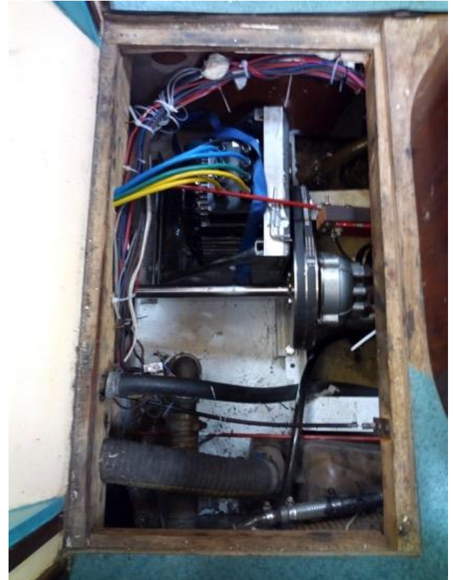
Foto3: Hier zie je diezelfde schroefas, maar nu staat de elektromotor naast de as op de vrije witte plek van foto 2. De motor is met twee V-snaren verbonden met de grote pulley.
